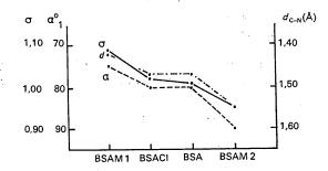
Fig. 7. Variations de  $\sigma$ ,  $\alpha_1$  et  $d_{C-N}$  dans BSAM1, BSAC1, BSA, BSAM2. (Pour BSAM1 on a admis un angle  $\alpha_1$  égal à la moyenne des deux valeurs théoriques possibles).
