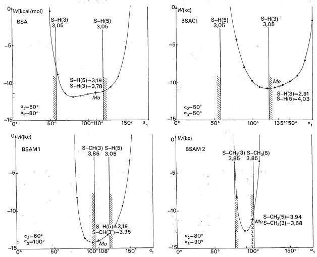
Fig. 6. Courbes d'énergie potentielle de van der Waals en fonction de l'angle  $\alpha_1$  pour  $\alpha_2$  et  $\alpha_3$  observés dans le cristal. Les zones hachurées correspondent à une pénétration des sphères d'encombrement dans le modèle théorique.  $M_0$ : Structure observée dans le cristal.
